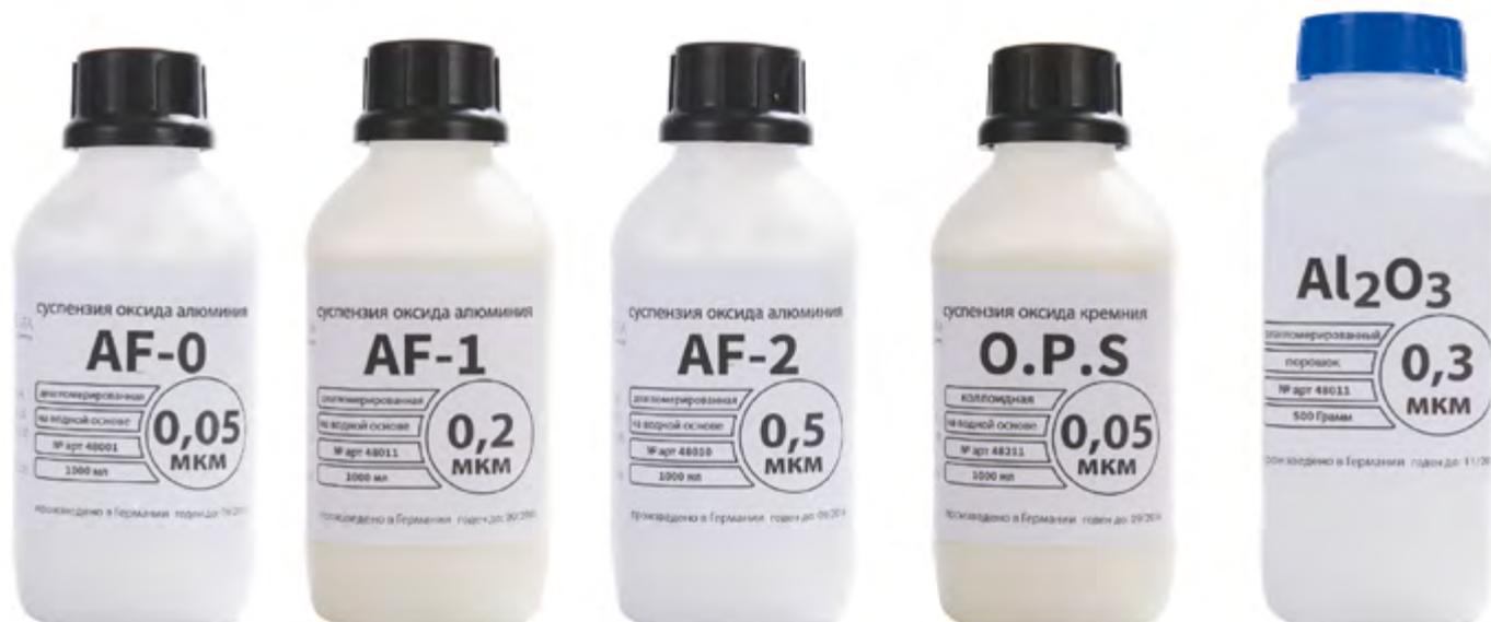
Суспензии оксидов металлов применяются для последнего шага полировки образцов для того, чтобы убрать остаточную деформацию поверхности. Кроме того, во время полировки оксидами часто возможно одновременное травление образца, применяя кислотные и щелочные реактивы. Для этого мы рекомендуем химически-стойкую полировальную ткань **Mambo**.
